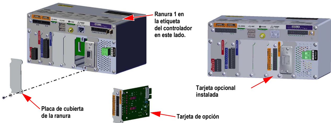
Figura 2-24. Instalación de la tarjeta opcional
